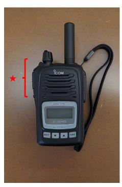
無線機上部の電源ボタン(ツマミ)を回転させると電源が ON になります。 OFF にしたい時は反対に回転させます。
