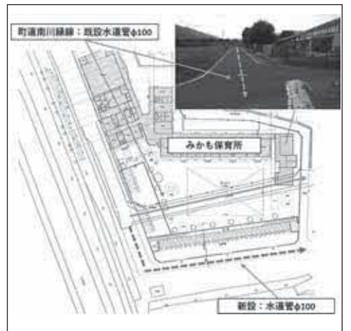
町道付け替えにより水道管も移設
